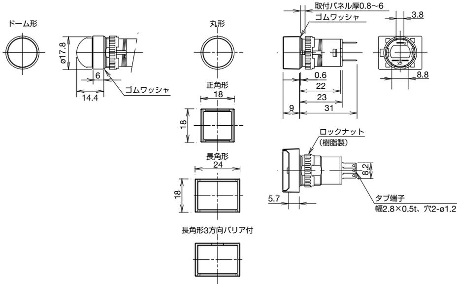
□ 取付穴加工図・最小取付ピッチ
