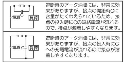
通常、直流誘導負荷は、抵抗負荷に比べ開閉が困難とされていますが、適切なアーク・キラーを用いると抵抗負荷と同程度まで性能が向上します。
