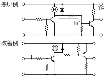
リレーの動作と同時に別信号を取り出す場合、回路上注意が必要です。例えば、悪い例では暗電流I<sub>0</sub>が流れます。暗電流がリレーコイルに流れると復帰不良や、耐振動、耐衝撃の低下をまねくことがあります。
