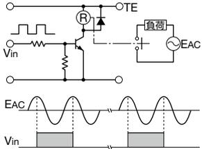
リレー接点を電源電圧に同期して開閉する場合、寿命が低下することがあります。このような場合、回路に要求される信頼性とのバランスでリレーを選択してください。または、開閉時の位相がランダムになるかゼロ位相付近で開閉するようにしてください。
