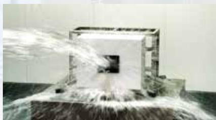
強い直接噴流による洗浄にも対応可能
