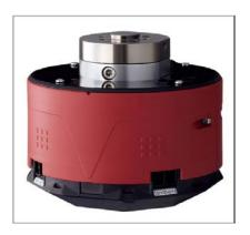
にしたものである。ロボットによる多種変量生産の時代において、ユーザー側でツメの部分の形状設計をするだけで、マルチハンドを間単に製作することができるようになったことは、製造の現場に大きな恩恵をもたらすだろう。また、省配管や省配線、ベースユニットの一部樹脂化によって軽量化し、荷搬重量 2kgまでの小型ロボットへの対応も実現した。エアーの省配管やケーブルの引き回しを工夫したことで、結果シンプルで特徴のある外観デザインを成立させたことも高く評価した。
